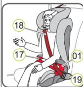
4. Coloque el cinturón diagonal (18) y el cinturón de pelvis (17) en el lado del broche del cinturón del vehículo (19) en la guía roja clara (01) del cojín del asiento.
