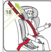
8. Tense el cinturón de seguridad tirando del cinturón diagonal (18).
