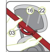
6. Pase el cinturón diagonal (16) por el soporte de color rojo oscuro (03) del reposacabezas (22), hasta que apoye, por completo y sin retorcerse, en el soporte del cinturón (03).
