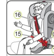
4. Coloque el cinturón diagonal (16) y el cinturón de pelvis (15) en el lado del broche del cinturón del vehículo (18) en la guía roja clara (05) del cojín del asiento.
