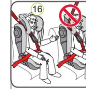
11. Tense el cinturón de seguridad tirando del cinturón diagonal (16).
