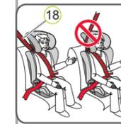
⚠ **¡PELIGRO!** El cinturón diagonal (18) debe estar dispuesto hacia atrás de forma transversal. Puede regular el cinturón con el desviador regulable de su vehículo.
