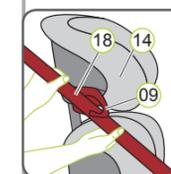
6. Pase el cinturón diagonal (18) por el soporte de color rojo oscuro (09) del reposacabezas (14), hasta que apoye, por completo y sin retorcerse, en el soporte del cinturón (09).
