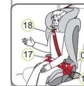
4. Coloque el cinturón diagonal (18) y el cinturón de pelvis (17) en el lado del broche del cinturón del vehículo (19) en la guía roja clara (06) del cojín del asiento.
