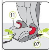
8. Mantenga presionada la tecla de ajuste ISOFIT (11) y saque completamente el brazo de enganche ISOFIT (07) más próximo a la puerta del vehículo.
