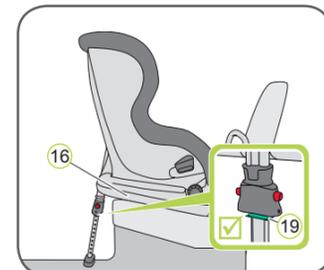
6. Presione ambos botones de ajuste (18) y tire de la pata de soporte (17) hasta que se apoye firmemente en el piso del vehículo. El indicador de la pata de soporte (19) debe estar completamente en verde.
