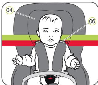
Un reposacabezas correctamente ajustado (04) garantiza la máxima protección para el niño en el asiento de seguridad:
