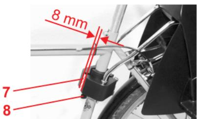
☞ Compruebe la ranura en la unión atornillada 7. Debe tener 8 mm para que los extremos del gancho se encaje con seguridad.
