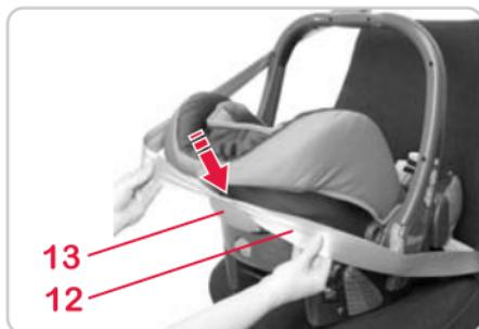
☞ Tire del cinturón diagonal **12** situado detrás del cabezal del portabebés.
