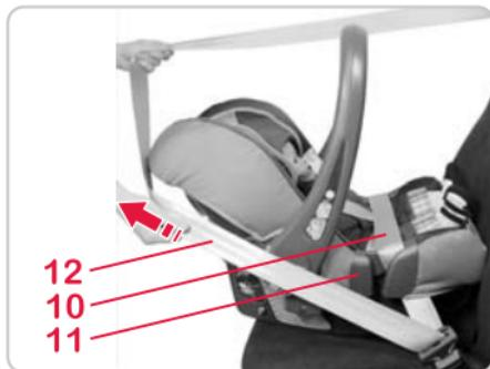
☞ Tense el cinturón de la cintura **10** tirando del cinturón diagonal **12**.
