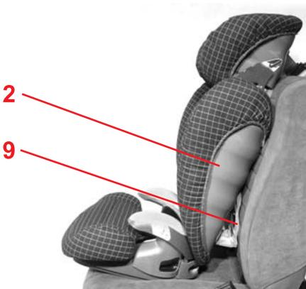
✎ Ahora, incline el respaldo **2** hacia atrás, hasta que la superficie del respaldo quede completamente pegada **9** al respaldo del asiento del vehículo. **¡Cuidado!** No incline el respaldo **2** más de lo que indica el ángulo de distancia **9**.
