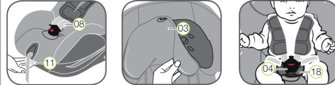
1. Empuje la palanca de ajuste de inclinación 11 hacia arriba y desplace la bandeja del asiento 17 hacia atrás hasta alcanzar la posición vertical.
