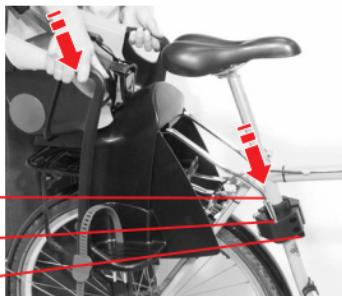
☞ Coloque el asiento de bicicleta para niños con el estribo de sujeción **9** en los agujeros de retención **10** hasta que se encaje.
