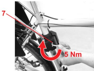
☞ Saque los tornillos **7** del soporte **5** con una llave allen (tamaño 5) con un par de apriete de 5 Nm.
