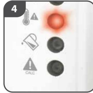
Espere a que la luz de advertencia de depósito vacío se apague. Se encenderá la luz de depósito de agua caliente.
