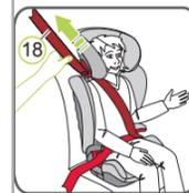
**⚠ PERIGO!** O cinto diagonal 18 tem de passar para trás na diagonal. Pode regular a passagem do cinto com o regulador ajustável do cinto seu veículo.
