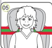
1. Pegue no cabo de ajuste 06 no lado traseiro do apoio para a cabeça 05 e puxe-o para cima. Agora o apoio para a cabeça está desbloqueado.
