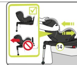
8. Mueva de un lado a otro el asiento infantil para vehículos para asegurarse de que está firmemente sujeto, y vuelva a comprobar que los dos indicadores ISOFIX (14) están completamente iluminados en verde. → El asiento del vehículo estará ahora completamente instalado.
